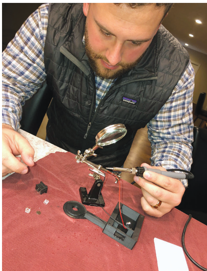
Drew Deathe soude les composantes électroniques pour le microscope imprimé sur 3D qui peut être attaché à un téléphone mobile pour évaluer les symptômes du trachome.
